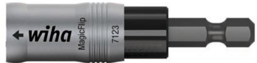
Acier inoxydable et matière plastique renforcée de fibres de verre. Pour embouts selon DIN 3126, ISO 1173 forme C 6,3. DIN 3126, ISO 1173, forme E 6,3. Pour un vissage aisé des vis, un puissant aimant néodyme maintient la vis de manière sûre. La bague aimantée peut être activée/désactivée selon les besoins. Système FlipBack - la douille revient automatiquement en arrière dans la dernière phase de vissage et libère la vue sur la tête de vis. Ce qui permet un enfoncement ciblé.
