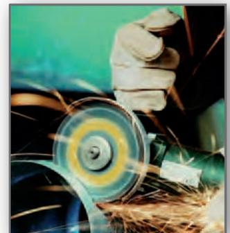
Disque à tronçonner à haut rendement pour profiles minces et tubes.
