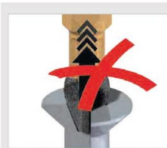
Le revêtement Dura réduit les forces de dérapage à un minimum imbattable – l'embout ne dérape pas de la tête de la vis!
